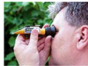
Slika 3. Ručni refraktometar – brza kontrola sadržaja šećera u vinogradu
