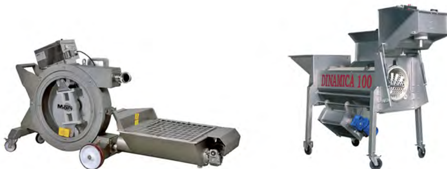
Slika 4. Muljača – ruljača, selekcioni sto i peristaltik pumpa za kljuk
