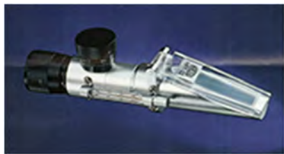
Slika 3. Ručni refraktometar – brza kontrola sadržaja šećera u vinogradu
